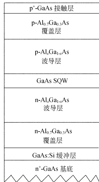
图 1 808 nm 半导体激光器外延芯片结构
